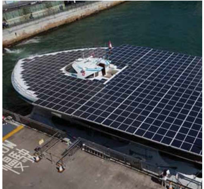
Tûranor PlanetSolar は、甲板が500m 2 の太陽電池パネルで覆われた世界最大の太陽エネルギー駆動の船舶で、太陽電池で世界を一周できる最初の乗り物であった。 © Tatiana Kakhil/Stock
