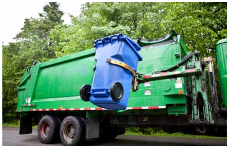
リサイクルのための住居からの廃棄物を集めるロボットアームを備えた市のトラック © Paul Vasarhelyi/iStock
